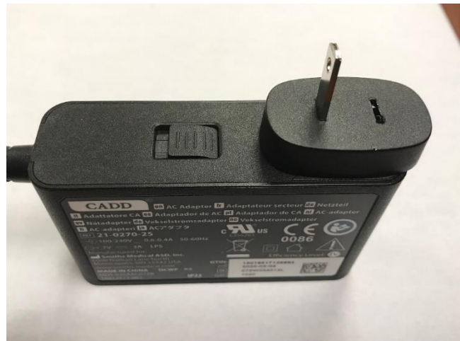
Figure 3: Adaptateur secteur présentant une broche manquante
