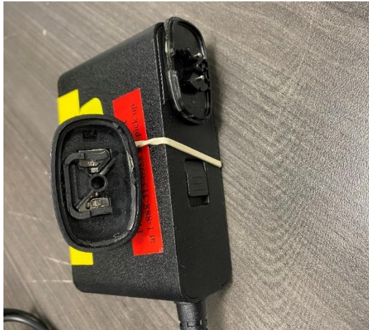
Figure 2: Fiche d'entrée endommagée
