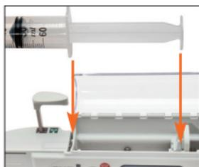
3. Placer les ailettes de la seringue à la verticale dans la fente et l'embout de la seringue dans le chariot.
