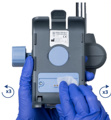
Figure 11.1. Nettoyage des connecteurs électriques
